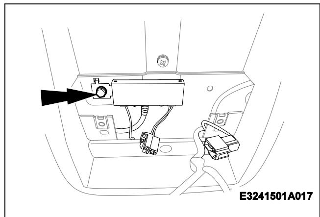
◀4.拆卸天线放大器 1 个固定螺栓。
