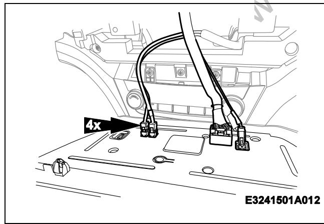
◆6. 断开多媒体音响面板总成（带导航）的4个线束插头。
